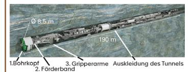
Erkläre die Teile 1 bis 3 der Tunnelbohrmaschine.
